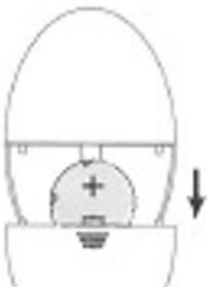
Primero, retire el control remoto hacia abajo y coloque la batería en la ranura correspondiente, asegurándose de que el terminal positivo de la batería esté orientado hacia arriba; luego, cierre el control remoto.
